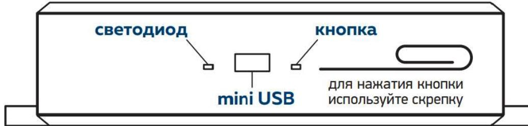
и включите зажигание, нужно дождаться одной вспышки зеленого светодиода и выключить зажигание.
