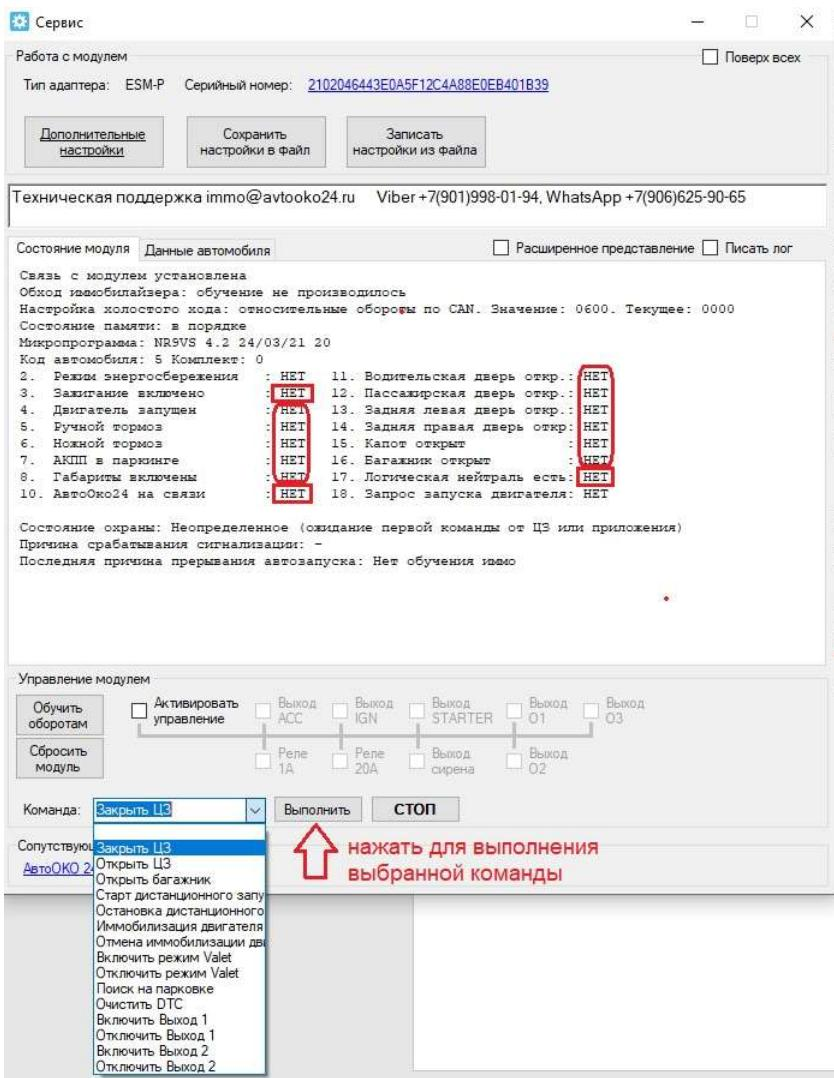
**Параметр 10 «АвтоОко24 на связи»** – отображает наличие связи с трекером и меняет свое состояние (да/нет) в зависимости от физического подключения трекера к разъему 8-pin жгута Разъем-в-Разъем.
