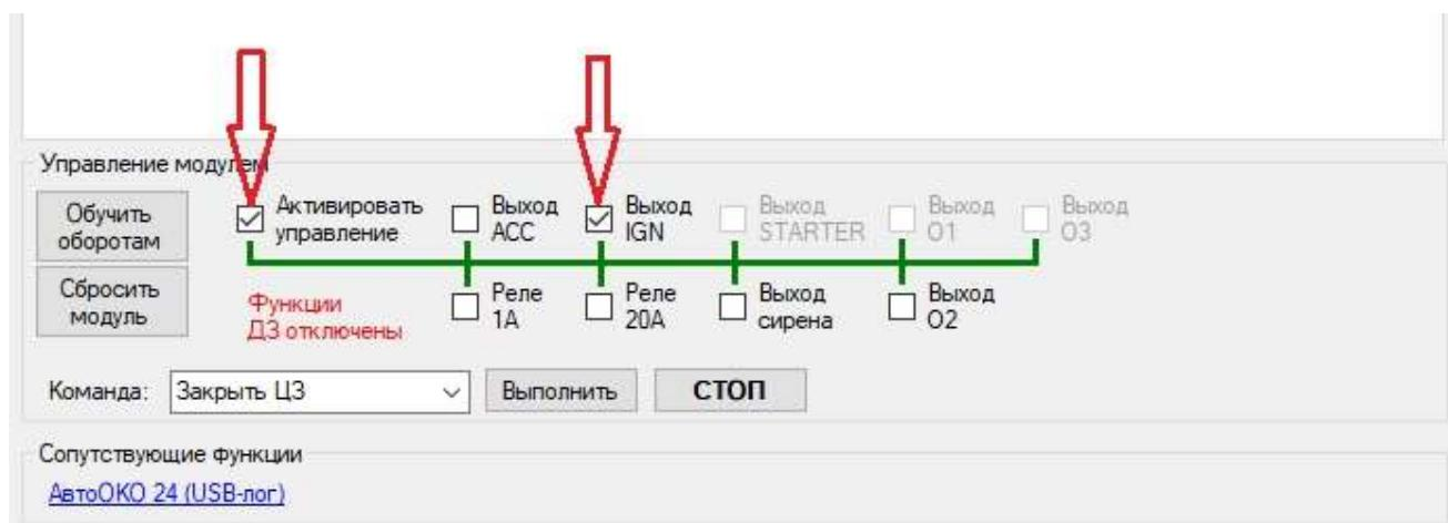
В блоке «Управление модулем» окна «Сервис и диагностика» необходимо поставить две галочки как на рисунке выше, при исправности выхода управления зажиганием в автомобиле включится зажигание, если этого не происходит необходимо проверить силовой предохранитель 30 А на модуле запуска и надежность подключения силового желтого провода в транзите замка зажигания.
