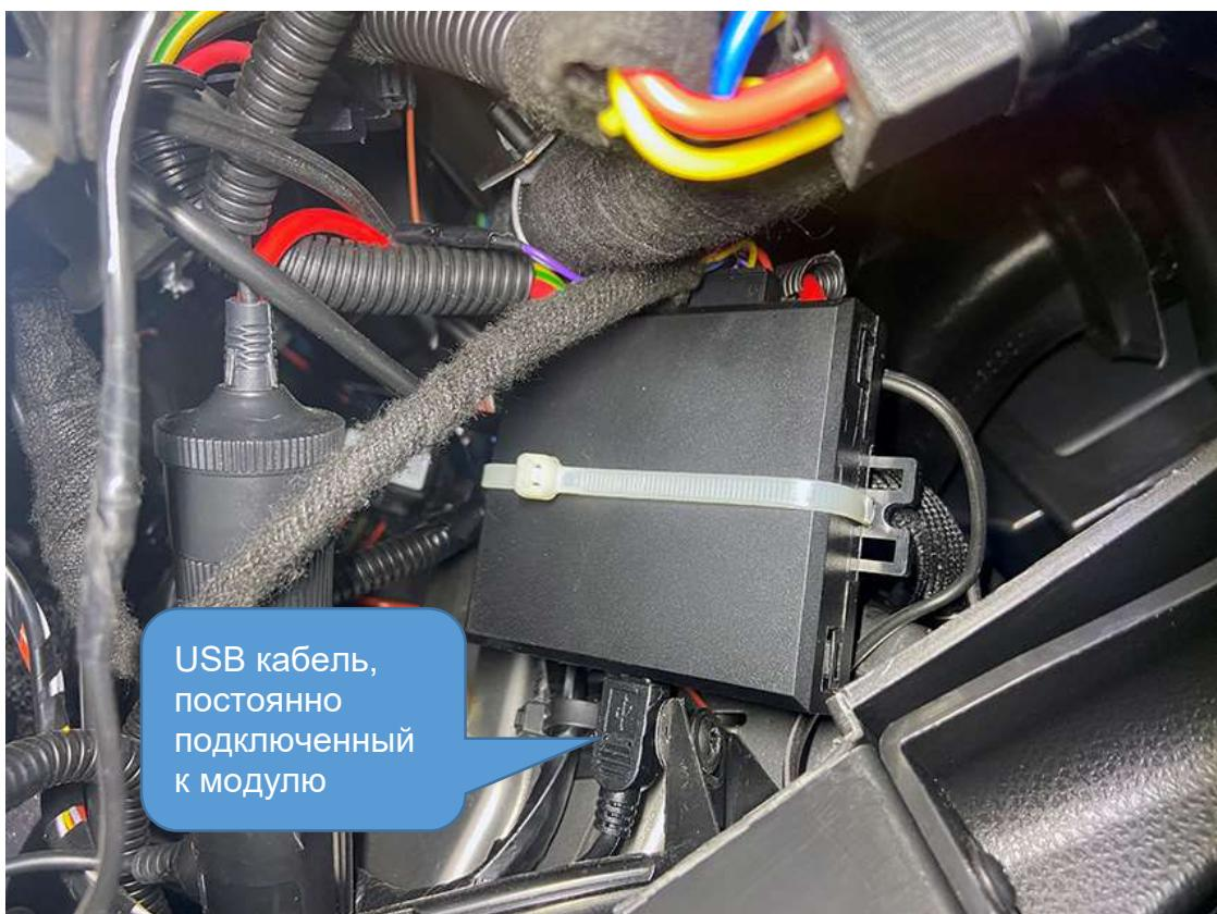
2. Протяните часть жгута с OBD-II транзитом за центральным тоннелем для подключения в бардачке. Часть жгута для подключения к разъемам модуля BCM протяните над рулевым валом. Убедитесь, что при изменении регулировки наклона колонки хватает длины кабеля и нет никаких зажиманий жгута деталями колонки.
