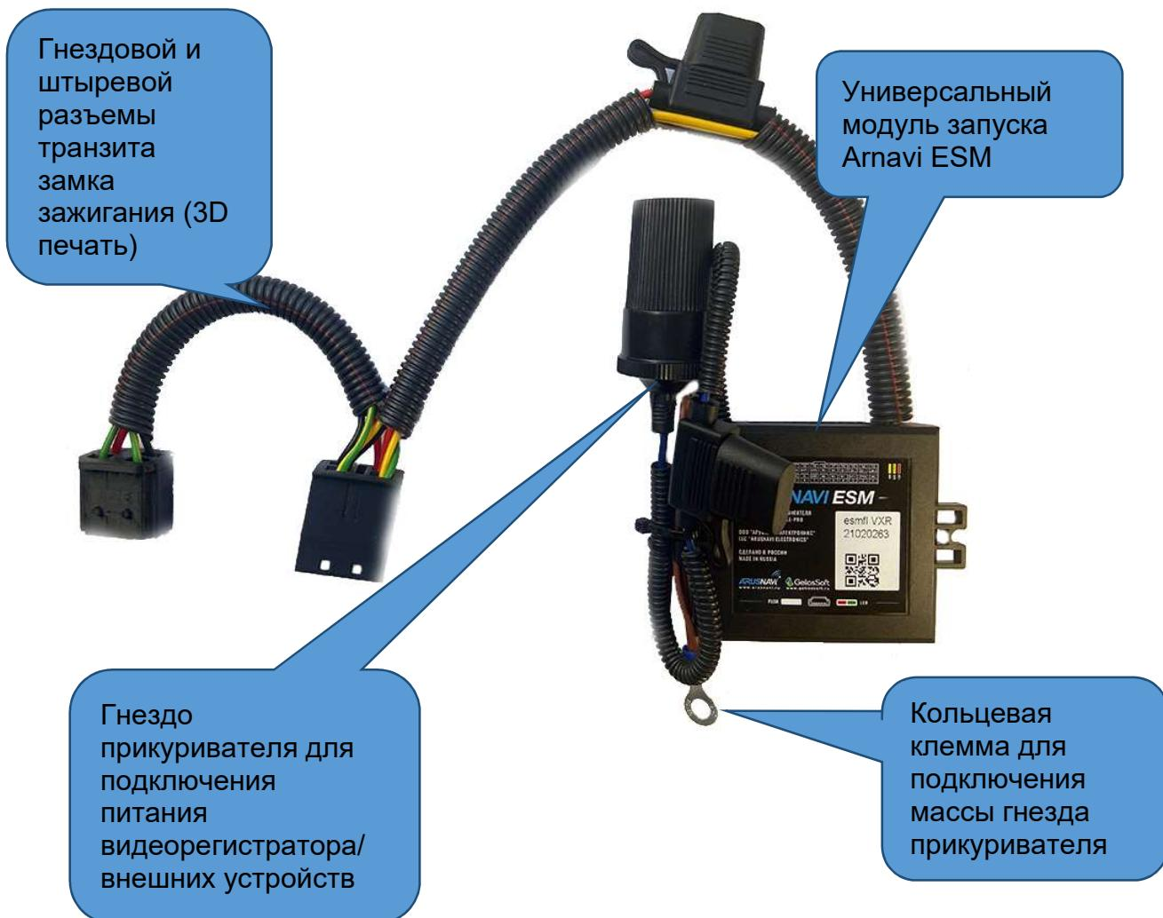
В базовой поставке комплекс поставляется с аналогами штатных силовых разъемов. При покупке, можно выбрать комплектацию модуля запуска с оригинальными силовыми разъемами и контактами ТЕ. Гнездо прикуривателя для подключения видеорегистратора поставляется опционально в зависимости от выбранной комплектации.
