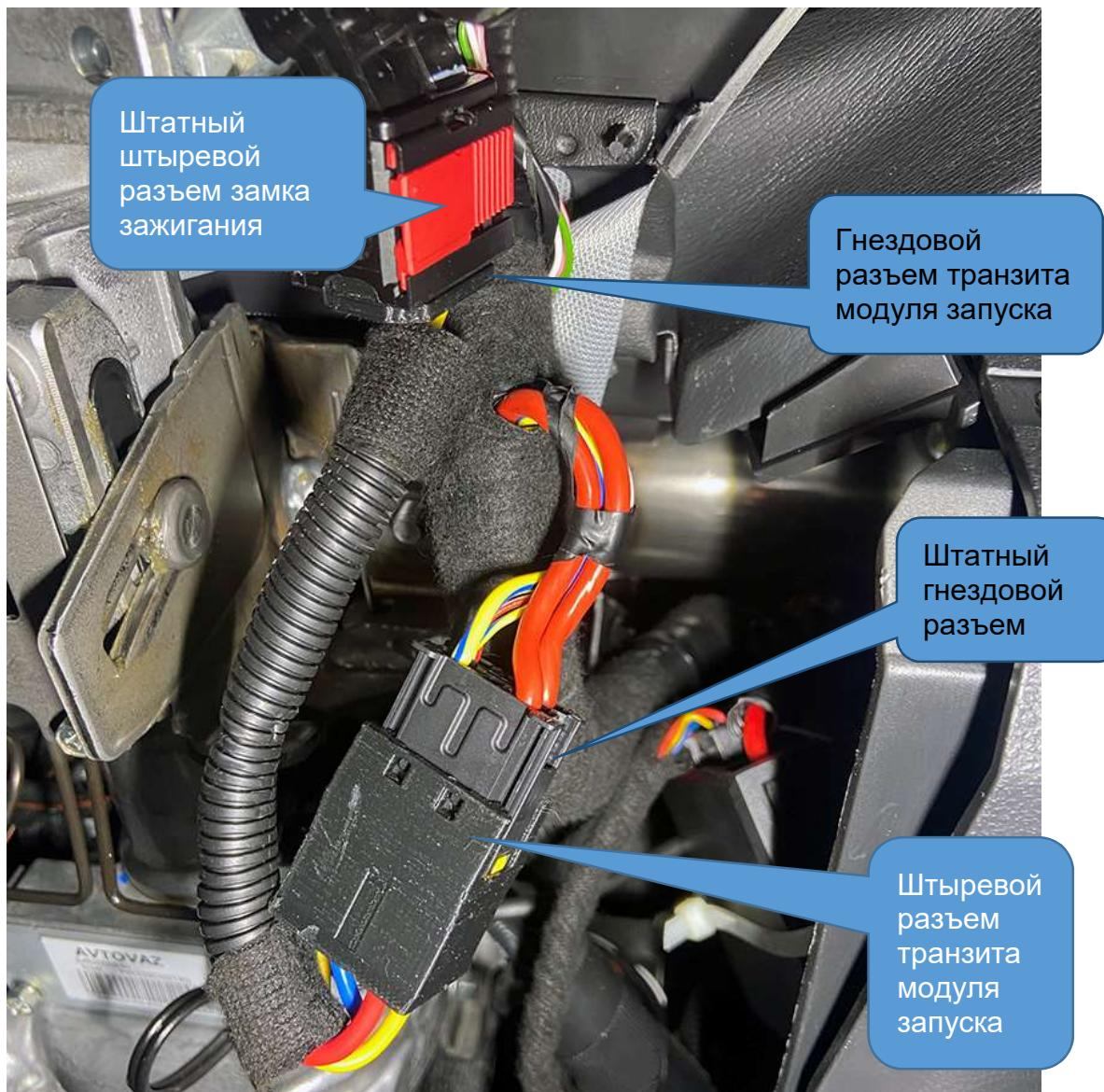
Соединённые вместе штатный гнездовой разъем замка зажигания и транзитный штыревой разъем модуля запуска. Закрепите с помощью пластиковой стяжки к штатному жгуту. Аналогично закрепите сам модуль запуска. Рекомендуем ориентировать модуль-USB разъемом вниз, для будущих обновлений и настроек системы mini-USB кабель можно оставить подключенным.
