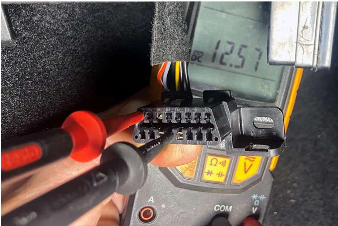
При отсутствии проблем в цепях питания штатного диагностического гнезда, показания постоянного напряжения
