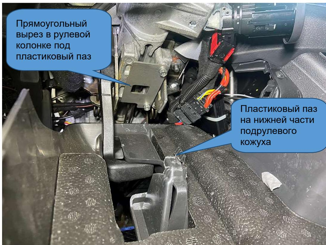
2. Протяните часть жгута с OBD-II транзитом и разъемом 8-pin для подключения трекера над рулевым валом. Убедитесь, что при изменении регулировки наклона и выноса колонки хватает длины кабеля и нет никаких зажиманий жгута деталями колонки.
