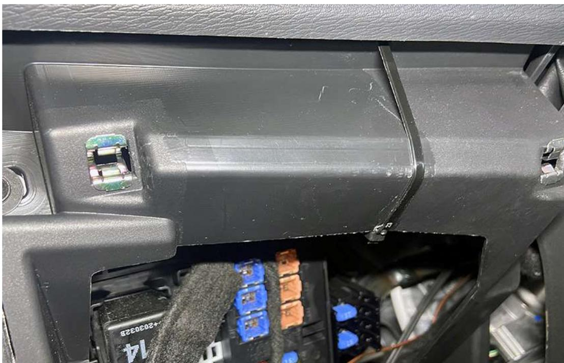
4. Для автомобилей LADA Vesta с МКПП до 2017 г. Выпуска, а также с роботизированной трансмиссией или вариатором подключение в модуле BCM под бардачком в сером разьеме пары проводов, помеченных белой термоусадкой в параллельно красно/синему проводу является обязательным!
