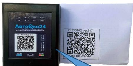
QR-код (на инструкции и наклейке), содержащий IMEI устройства.
